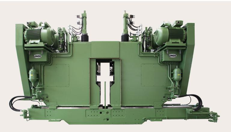
Die Maschinehälften der VPM sind auf Linearführungen gelagert. Die Führungslänge ist so gewählt, dass in Werkzeugwechselposition ein großzügig bemessener Raum für den Werkzeugwechsel vorhanden ist.
