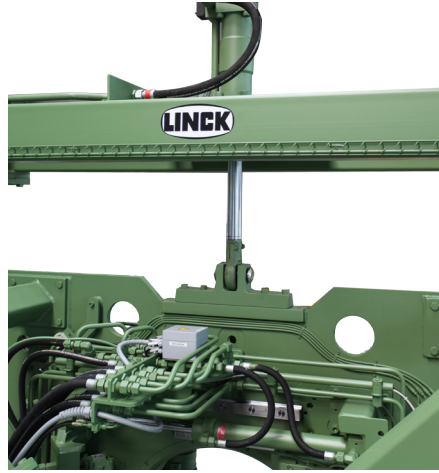
Hydraulischer Servozylinder zur Höhenverstellung des Rotors
